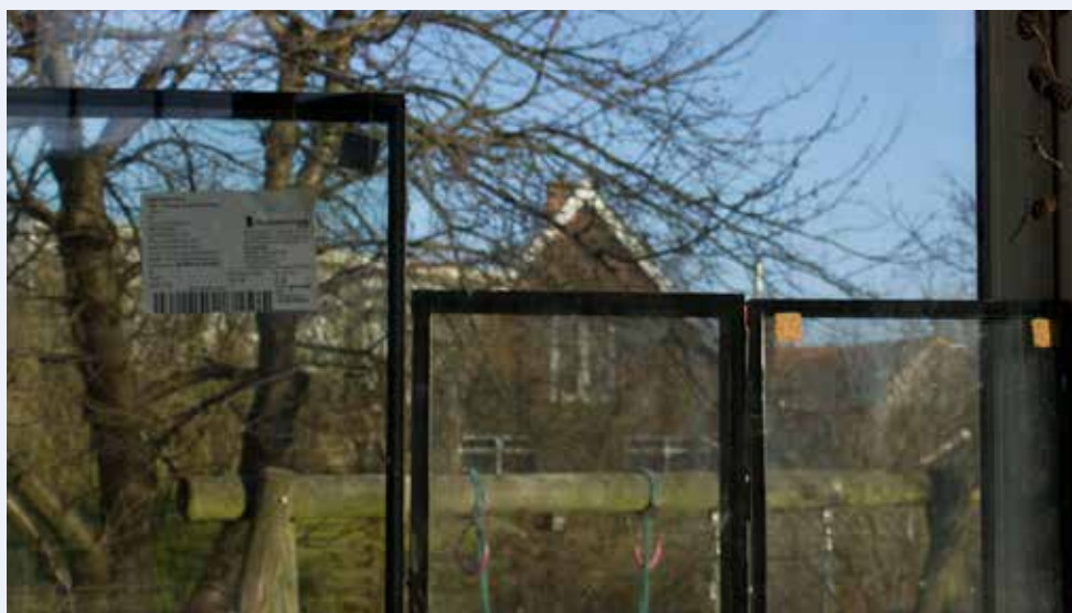
Fig 3. Rudetyper. 2-lags energirude med jernfattigt glas (th) og 3-lags standard energirude i midten. 3-lags energirude med jernfattigt glas som supplerende reference i laboratoriemålinger (tv)
