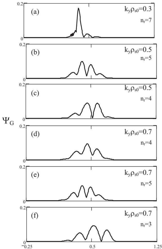
FIG. 8. Eigenfunction  $\Psi_G$  of the six unstable GAMs for  $\varepsilon_n=0.1$ ,  $\rho_{s0}/L_n=0.02$ , and  $\Phi_0=2 \times 10^{-3}$ , (a)  $k_y \rho_{s0}=0.3$ ,  $n_r=7$ , (b)  $k_y \rho_{s0}=0.5$ ,  $n_r=5$ , (c)  $k_y \rho_{s0}=0.5$ ,  $n_r=4$  (d)  $k_y \rho_{s0}=0.7$ ,  $n_r=4$ , (e)  $k_y \rho_{s0}=0.7$ ,  $n_r=5$ , and (f)  $k_y \rho_{s0}=0.7$ ,  $n_r=3$ .
