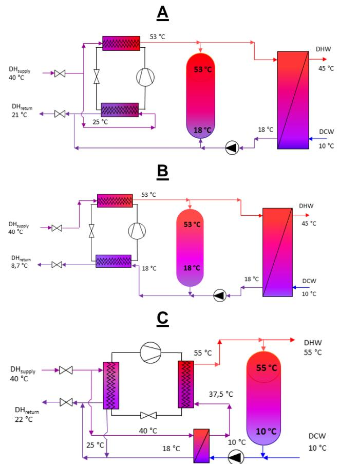
Figure 1 Analysed microbooster heat pump DHW concepts
